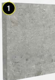
1 Beton s předběžnou úpravou podle CSP 3-6
