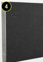
4 XS-101: společnosti LINE-X: Tloušťka 2,0-2,5 mm
