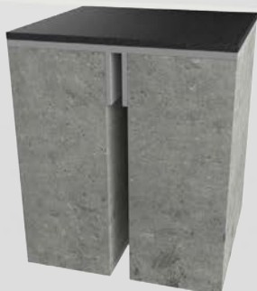
Jestliže očekávaný pohyb je větší než 2 mm, potom proveďte oddělení pomocí proužku plastu, který bude 4x větší než původní velikost spoje
