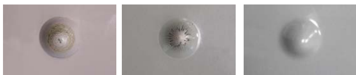
NÁTĚR: (K SELHÁNÍ DOŠLO PŘI 4,5 newton metru)
