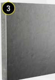
3 Schválený základní nátěr LINE-X (druhá mokrá vrstva) a křemenný písek vysušený v peci v množství přibližně 1 kg/m 2 .
